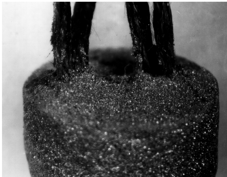
Abbildung 4.11 : Sensor aus rekristallisationsgesintertem SiC nach Einsatz mit Bornitrid als Isolierkeramik
