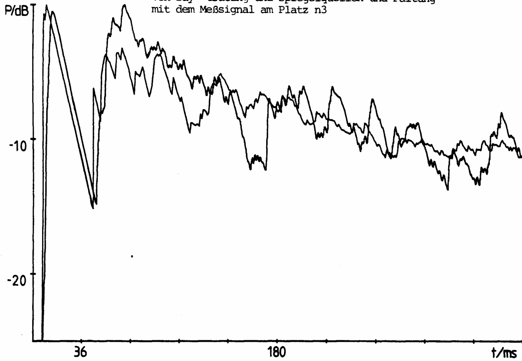
Abbildung 33 : Gewichtet geglättete quadrierte Impulsantwort von Messung, ray- tracing und Spiegelquellen und Faltung mit dem Meßsignal am Platz n3
